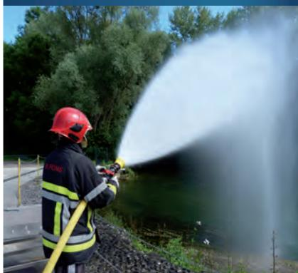
Le cône plein de cette position assure une capacité d'extinction **maximale** et repousse **puissamment** les flammes.
